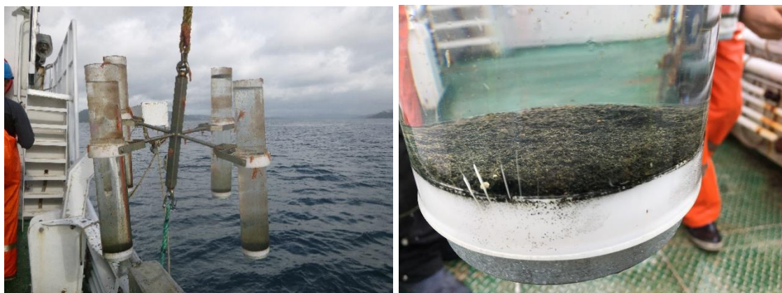
Figur 35 Innhenting av sedimentfeller fra ST11 Ytre Puddefjorden, august 2019. Venstre: nivå 3, røråpning -20 m. Høyre: nivå 1, røråpning - 98,5 m og 1,5 m over sjøbunnen.
