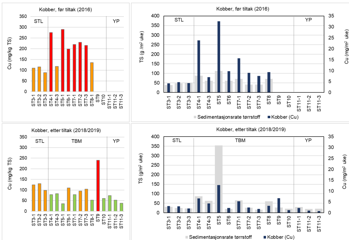
Figur 42 Sammenstilling av gjennomsnittlig mengde sedimentert materiale og mengde sedimentert kobber i sedimentfeller før tiltak (COWI, 2017) og etter tiltak. Figurene til venstre viser konsentrasjon kobber, stolpene er fargelagt etter tilstandsklasse (M-608). Figurene til høyre viser mengde sedimentert materiale (TS) og mengde sedimentert kobber. STL: Store Lungegårdsvann (utenfor tiltaksområdet), TBM: tildekket areal inkludert passiv tildekking (kap. 5.2.2), YP: Ytre Puddefjord (utenfor tiltaksområdet).
