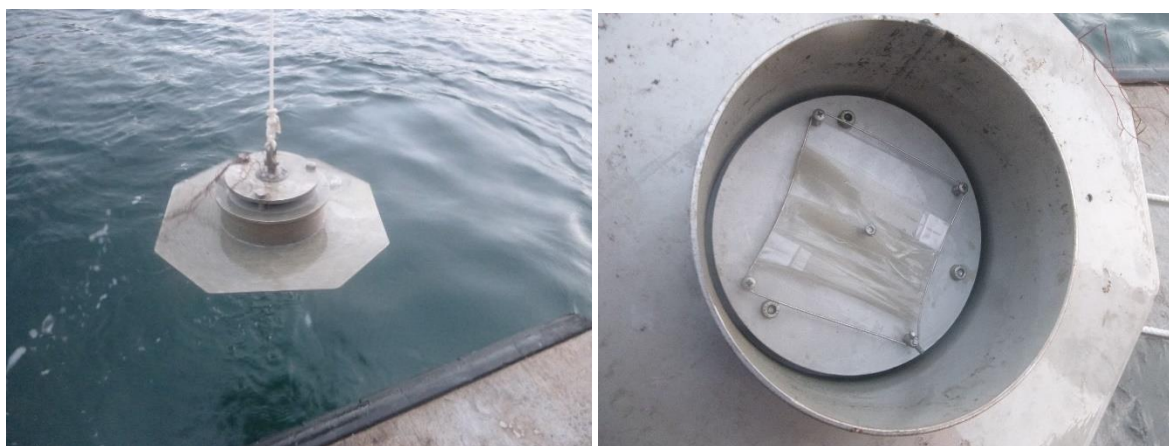
Figur 24 Bentisk flukskammer (venstre) og SPMD montert inne i flukskammeret (høyre).
