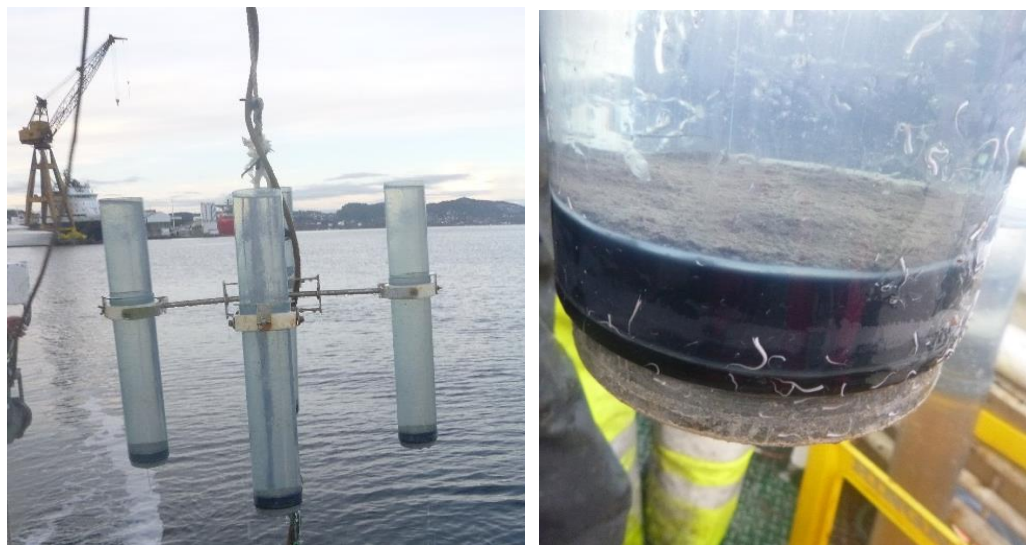
Figur 34 Innhenting av sedimentfeller fra ST-7 Damsgård, nivå 3, røråpning -13 m Damsgård, august 2019.
