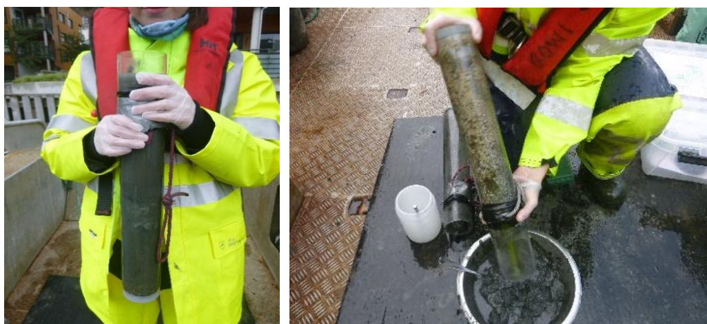
Figur 21 Bilder rør med prøvemateriale fra delfelt 1F (venstre) og opparbeiding av blandprøve fra delfelt 2A (høyre).
