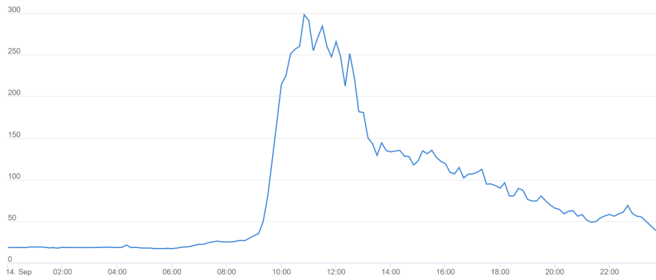
Figur 4 Turbiditetsmålinger i sedimentasjonsanleggets utløp 14. september.
