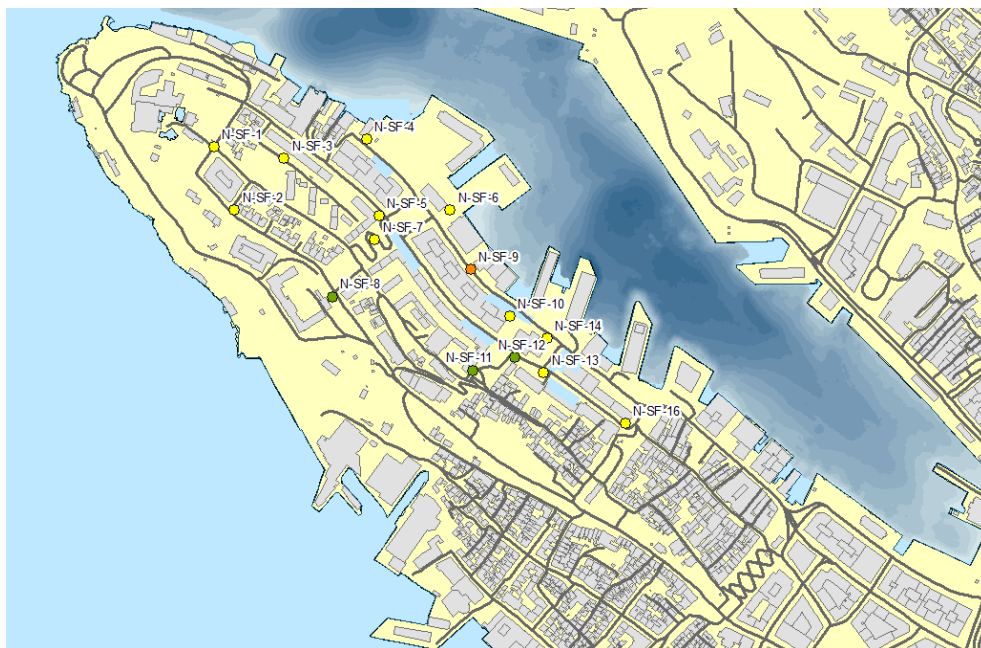
Figur 3 Innhold av PCB i sandfangsmateriale klassifisert etter tilstandsklasser for sediment (TA-2229/2007).
