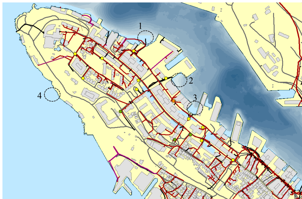
Figur 7 Planlagt plassering av målerigger. Rigg 1 og 2 står ved utløp av de mest brukte overløpene for avløpsvann. Målerigg 3 står utenfor område med mest PCB i sandfang. Målerigg 4 skal representere bakgrunnsverdi. Kartet viser klassifisering for PCB7.
