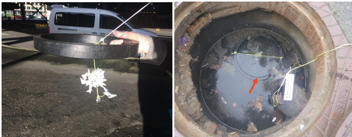
Figur 15 POM festet til sort plast-ring for bruk i sandfangskummer. Plast-ringen flyter i overflaten i sandfangskummen slik at prøvetakeren til enhver tid er eksponert for den øverste delen av vannet i kummen (ca. 10 cm under overflaten).
