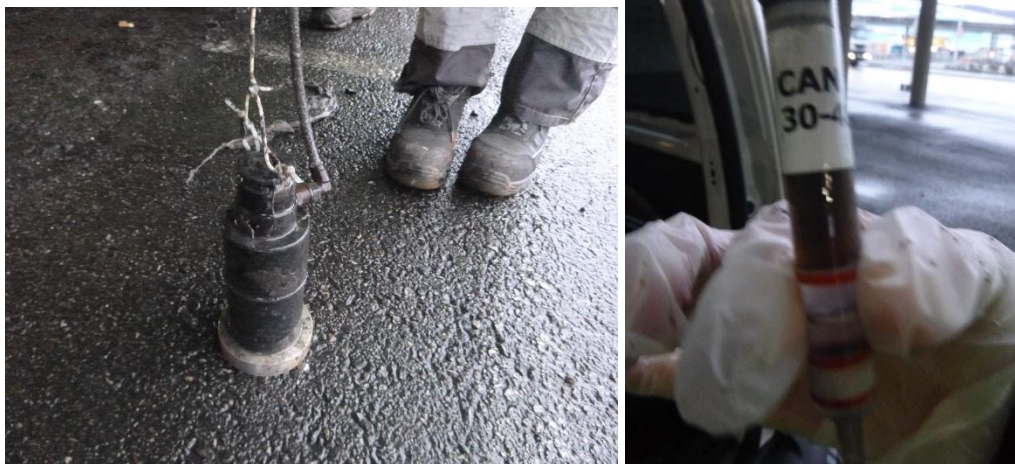
Figur 16 Innhenting av Sorbisense prøvetaker fra sandfangsskum S2.
