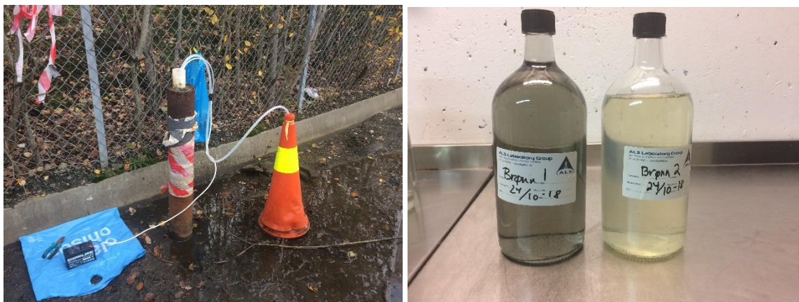
Figur 21 Pumping av brønn B1 (venstre) og vannprøvene tatt fra brønn B1 og B2 (høyre).
