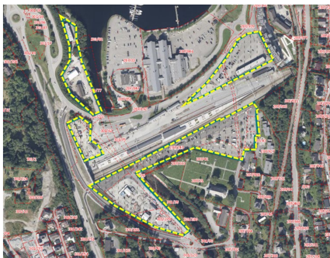
Figur 5-65: Alle områdene med gul stiptet linje skal brukes som riggområder for E16 og Vossebanen. Områdene med skravur er satt av i til riggområder i reguleringsplanen for E16 og Vossebanen. Det nordligste området (uten skravur) brukes i dag til rigg (Dobbeltspor Ulriken) og forutsettes å fortsatt benyttes som dette ved utbygging av E16 og Vossebanen.
