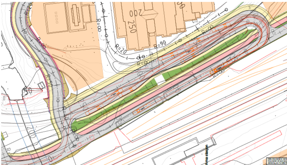
Figur 5-55: Sporing buss inne på kollektivterminalen samt i krysset ut fra kollektivterminalen mot vest. Bussen må ta i bruk noe av motsatt kjørebane.
