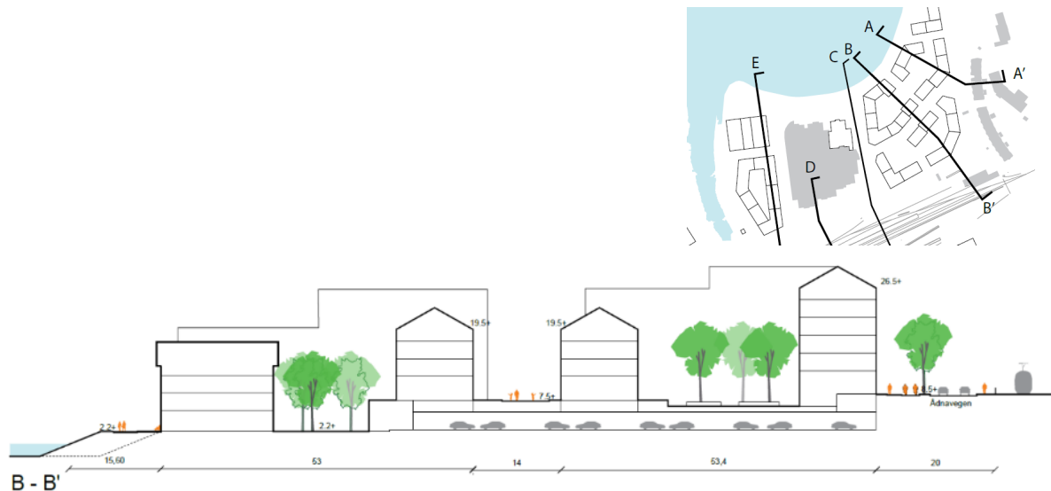
Figur 5-2: snittet viser hvordan et større parkeringsanlegg kan skjules under bakkenivå øst for dagens Øyrane Torg
