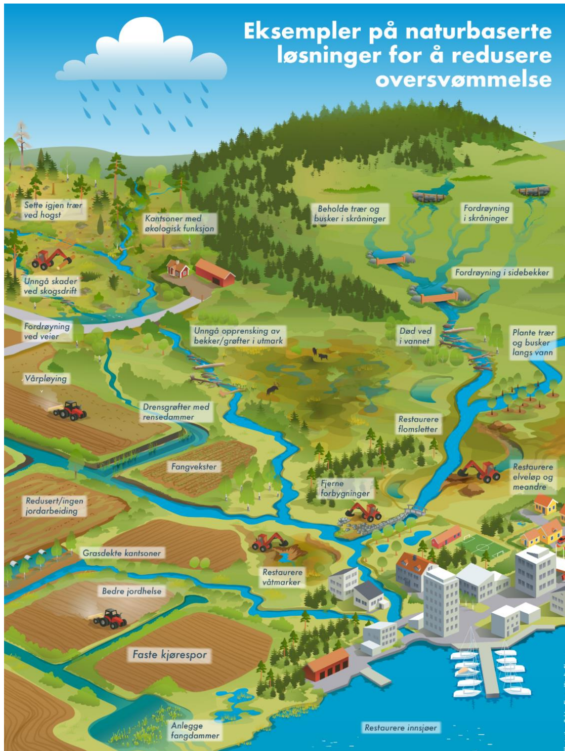
Figur 13 Eksempler på naturbaserte løsninger som kan holde tilbake vann og redusere oversvømmelse. Kilde: Miljødirektoratet, Landbruksdirektoratet og NVE (2020).
