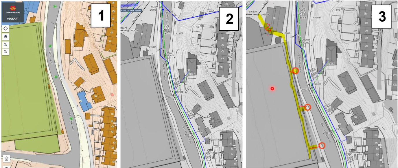
Figur 45 Kartutsnittene viser Øvre Fyllingsvei i 1) Vegkart (DNVB) grønne sirkler symboliserer kummer 2) kommunens VA-kart, svart strek symboliserer overvannsledning og svart sirkel er kum 3) skisse som viser faktisk situasjon der røde sirkler viser faktiske sandfang og gul strek symboliserer overvannsledning som har påslipp på kommunal overvannsledning.
