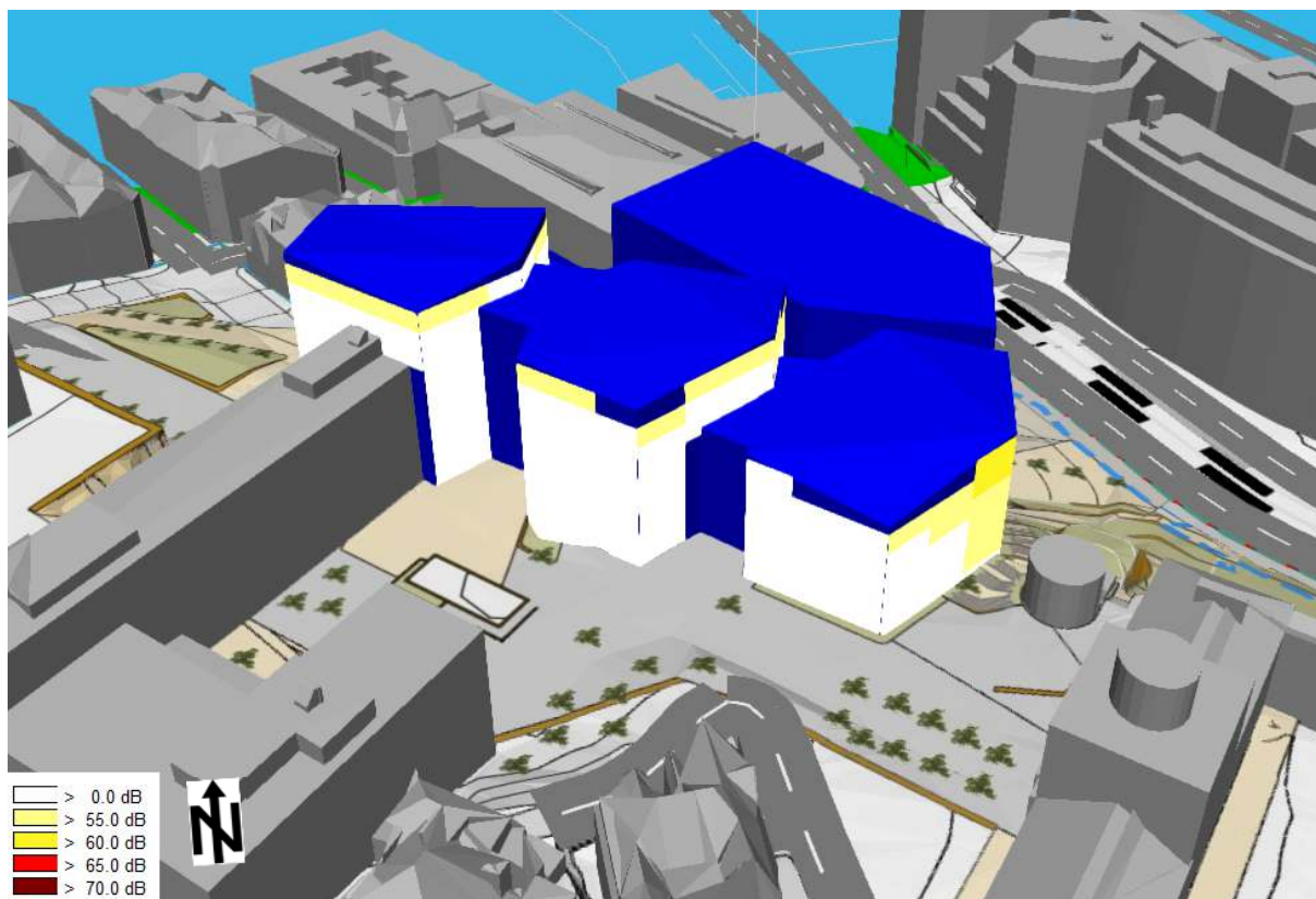
Figur 4-3: Støysituasjonen oppover etasjene til planlagte bygg. 3D utsnitt viser fasadenivåer av L_{den} . Sett fra sør.
