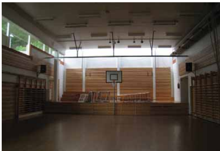
Gymnastikksalen med overlys langs kortveggen og vindusbånd på siden.
