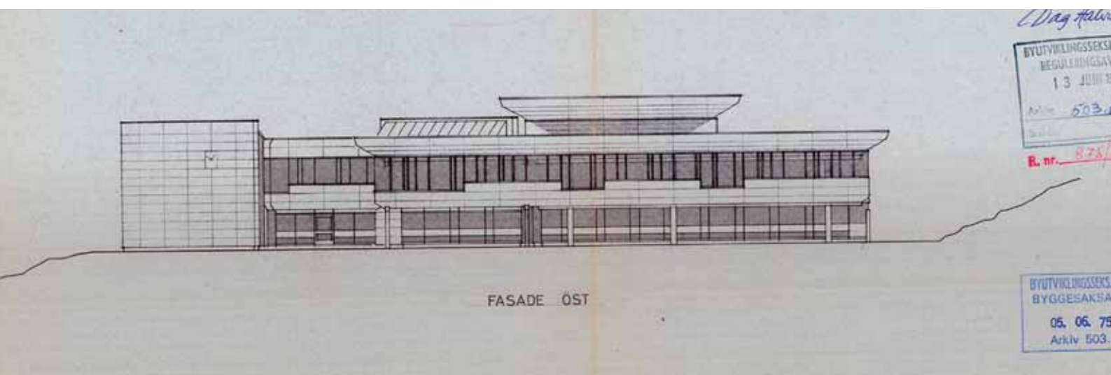
Hovedbyggets fasade mot øst. Lukket vegg i gymnastikksal. Vindusbånd i fasader. Ventilasjonsrom og overlys i volum øverst.
