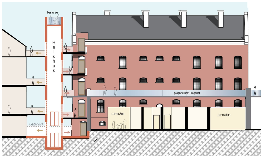
Figur 83: Prinsippsnitt av det nye Heisbygget og Luftegårdene
