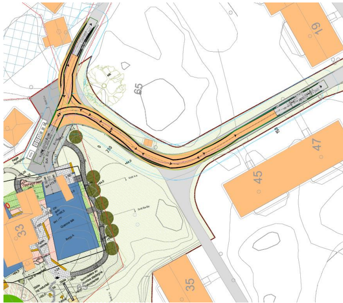
Figur 10: Viser sporing for lastebil 12m på området. Kartgrunnlag: Illustrasjonsplan
