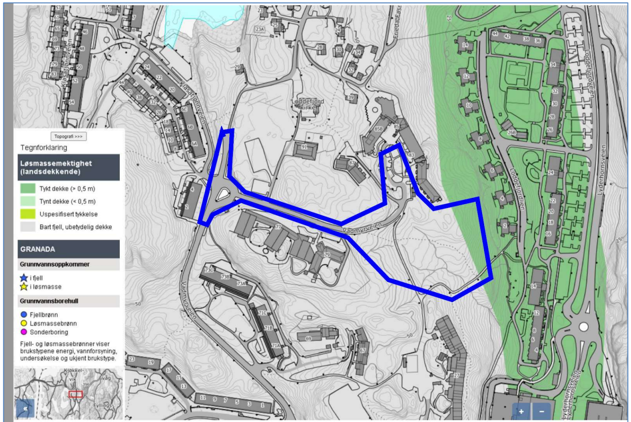
Figur 9 Figuren over viser løsmassekart fra NGU i planområdet. Det meste av planområdet (omtrentlig merket med blått) består av bart fjell, med stedvis tynt løsmassedekke
