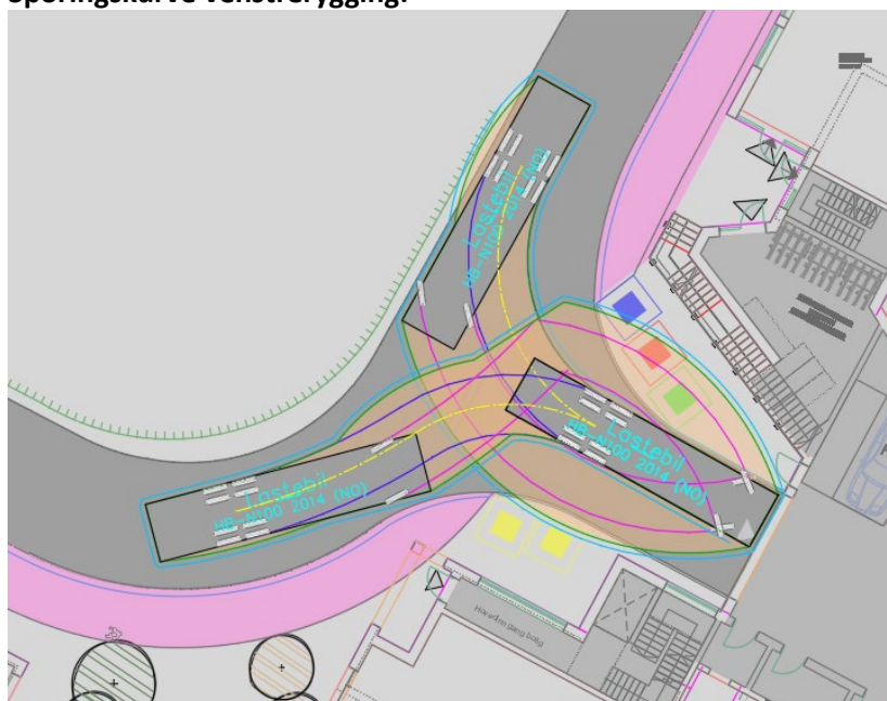
Figur 10 Skissert sporingskurve for venstretrygging. Med løsning, som vist over, vil kranbilen kjøre inn i snuhammeren, rygge til venstre ut i veien, kjøre frem i veien og rygge til venstre igjen inn i snuhammeren før henting. Dette får konsekvenser med veldig stort arealbeslag og flere snubevegelser.
