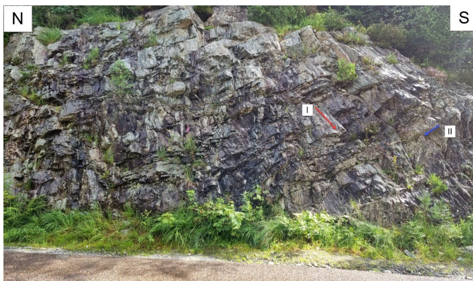
Figur 5. N-S gående skjæring i kartleggingsområdet. Det dominerende sprekkesettet følger lagdelingen og faller mot sør (rød pil). Det nest mest dominerende sprekkesettet faller mot nord (blå pil). Sprekkesettene står tilnærmet vinkelrett på hverandre og danner grove blokker.
