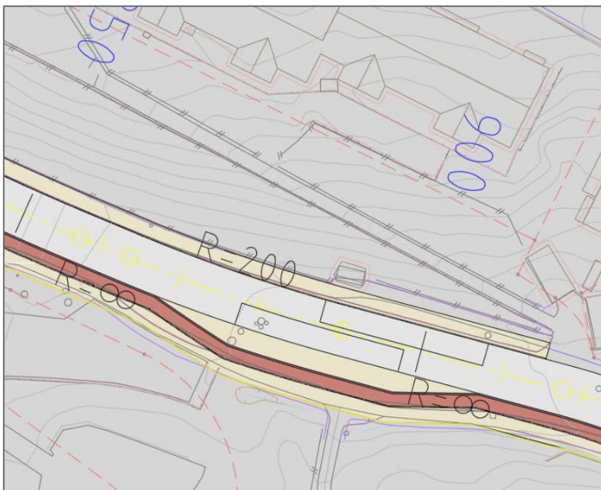
Figur 81 Strandlien holdeplass hvor sykkelfelt ledes bak holdeplass.
