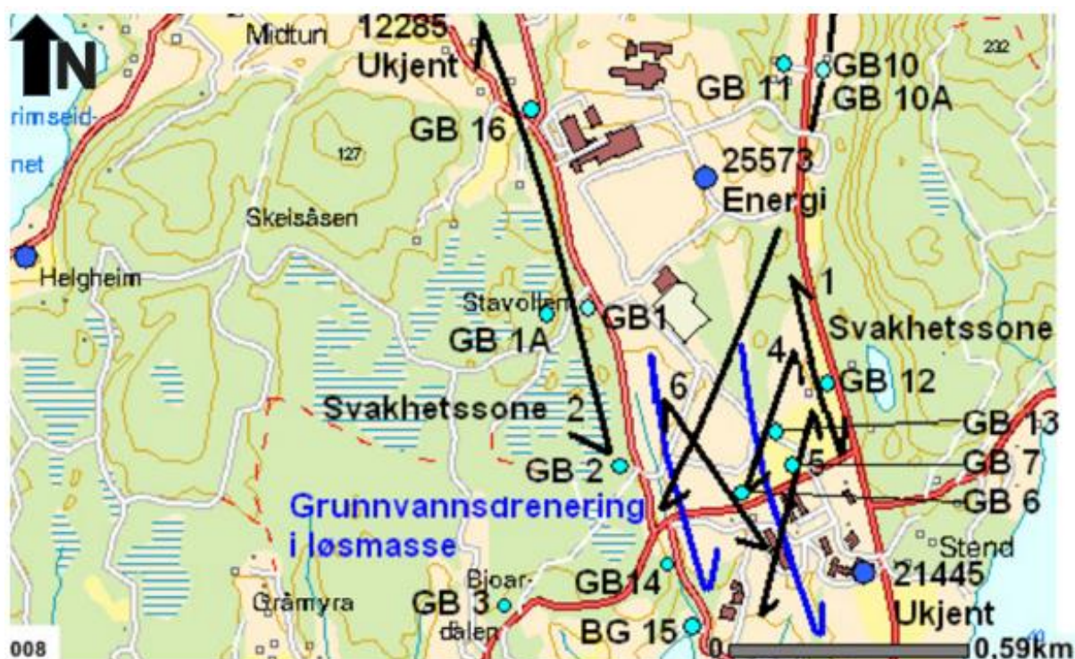
Figur 6-9: Brønner etablert i forbindelse med overvåking av grunn- og sigevann fra deponi. GB1A og GB10A ble etablert i 2004 som erstatning for hhv. GB1 og GB10. (COWI, 2009). I figuren er 13 brønner vist, ikke 14.
