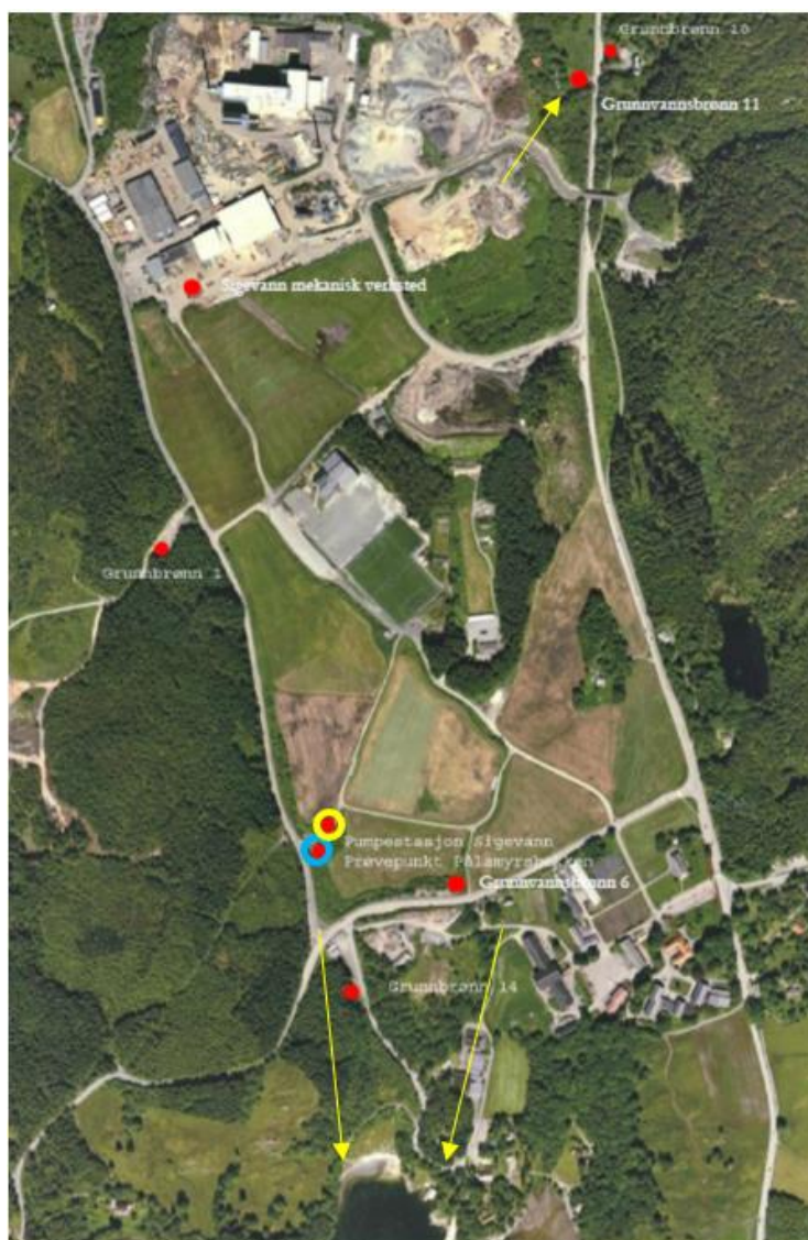
Figur 6-10: Oversiktskart over deponiområdet i Rådalen med fem prøvepunkter for grunnvann (Brønn 1, 6, 14, 11 og 16), Pålamyra pumpestasjon (gul sirkel) og Pålamyrsbekken (blå sirkel/overvann) (Øygard, 2011). Gule piler indikerer mulige veier for grunnvannsstrømming. Vannmengder måles i Pålamyra pumpestasjon.
