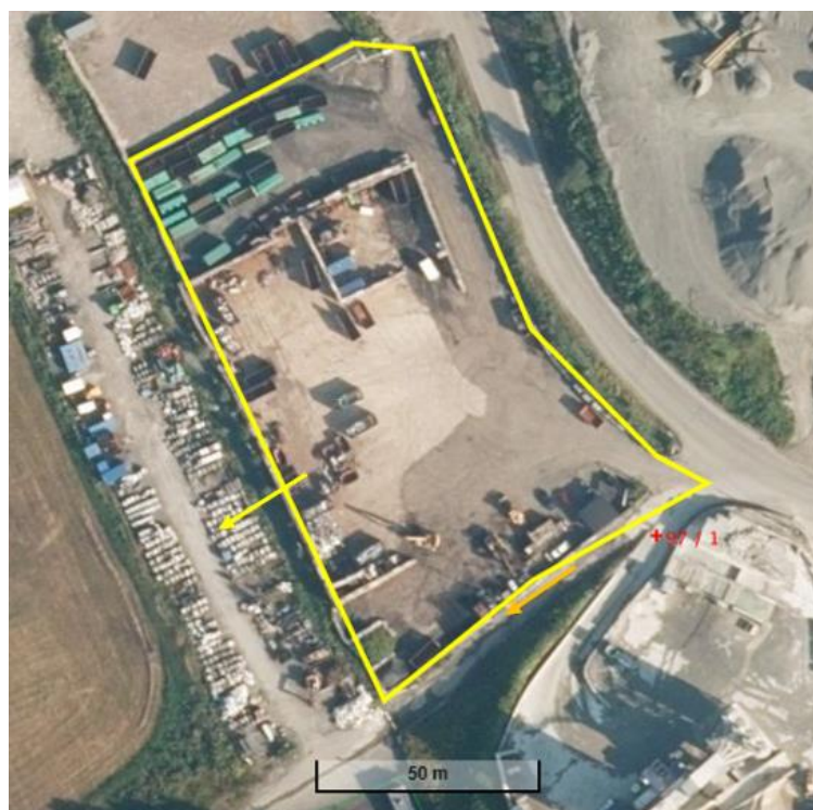
Figur 4-9: Omtrentlig avgrensning av arealet Norscrap West disponerer i Rådalen. Oransje pil viser overvannsgrøft på sørsiden. Gul pil viser hovedretningen på overvann fra området og retning på spillvannsledning som oljeutskiller drenerer til. Kartutsnitt er kopiert fra norgeskart.no
