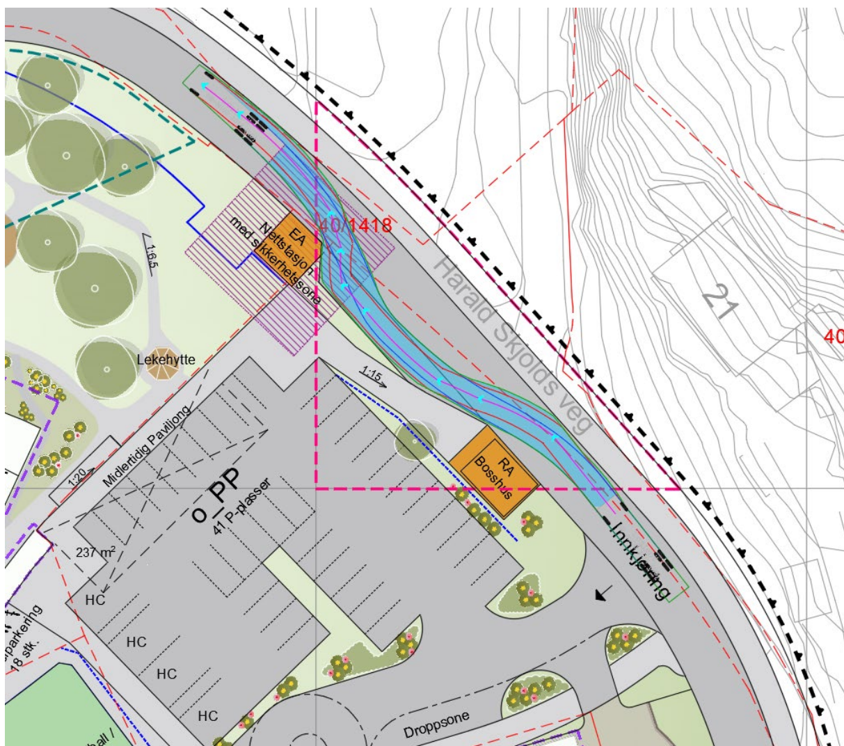
Figur 56 Sporingskurve for lastebil L i tilknytning til oppstilling innenfor felt o_SK1. (Det påpekes at illustrasjonsplanen er en utgått versjon, men det har ingen betydning for det som illustreres her.)
