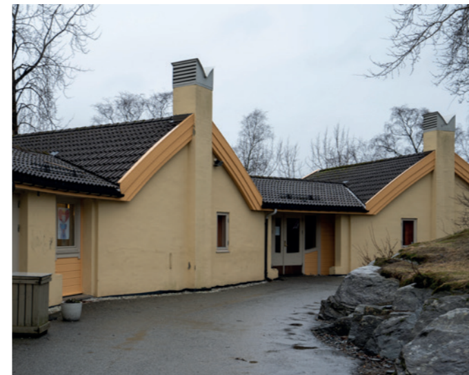
Tilkomst til bygg for barnetrinnet er på bakkenivå uten trapper eller ramper.
