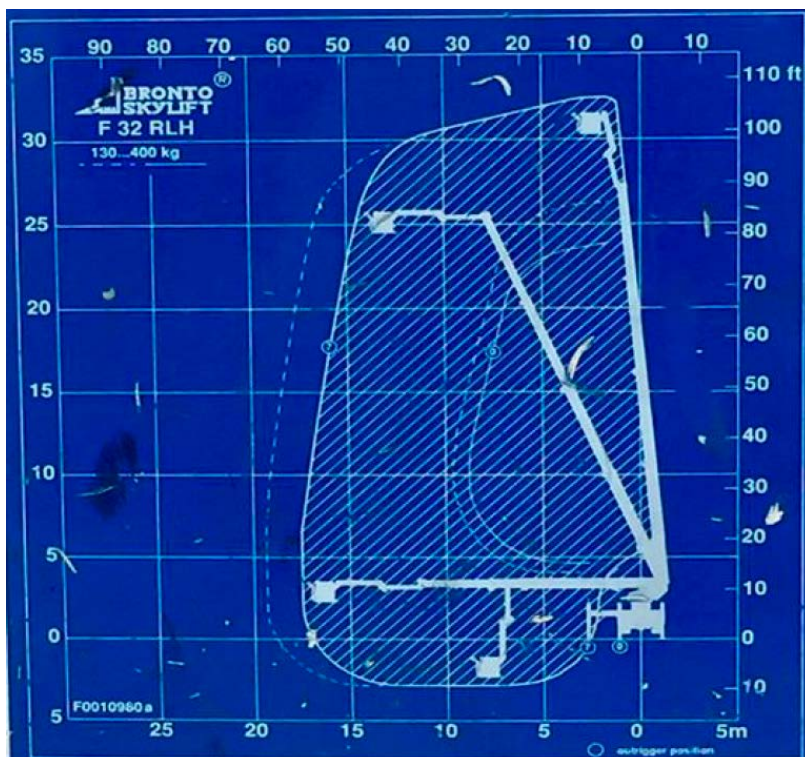
Figur 3-11: rekkevidde for høydeutstyr.
