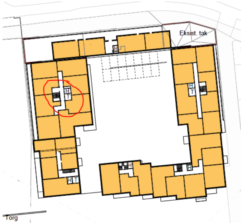
Figur 3-3: Bygg 8A, trapperommene markert i rødt.
