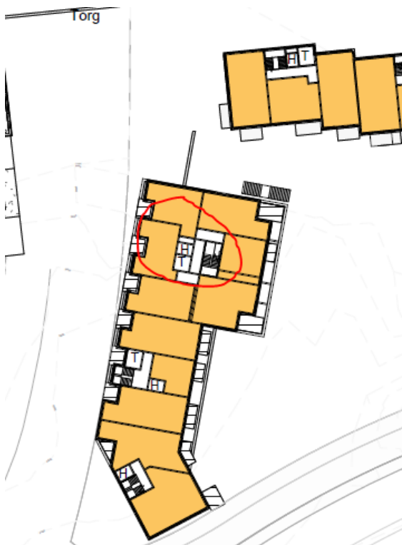
Figur 3-4: Bygg 10, trapperommene markert i rødt.
