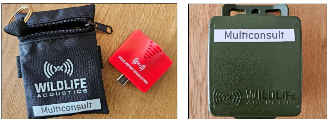
Figur 2-1 Echo Meter (t.v.) til avdekking av flaggermus og Song Meter (t.h.) som benyttes til lydopptak av fuglesang. Foto: M. Bjerga, Multiconsult.
