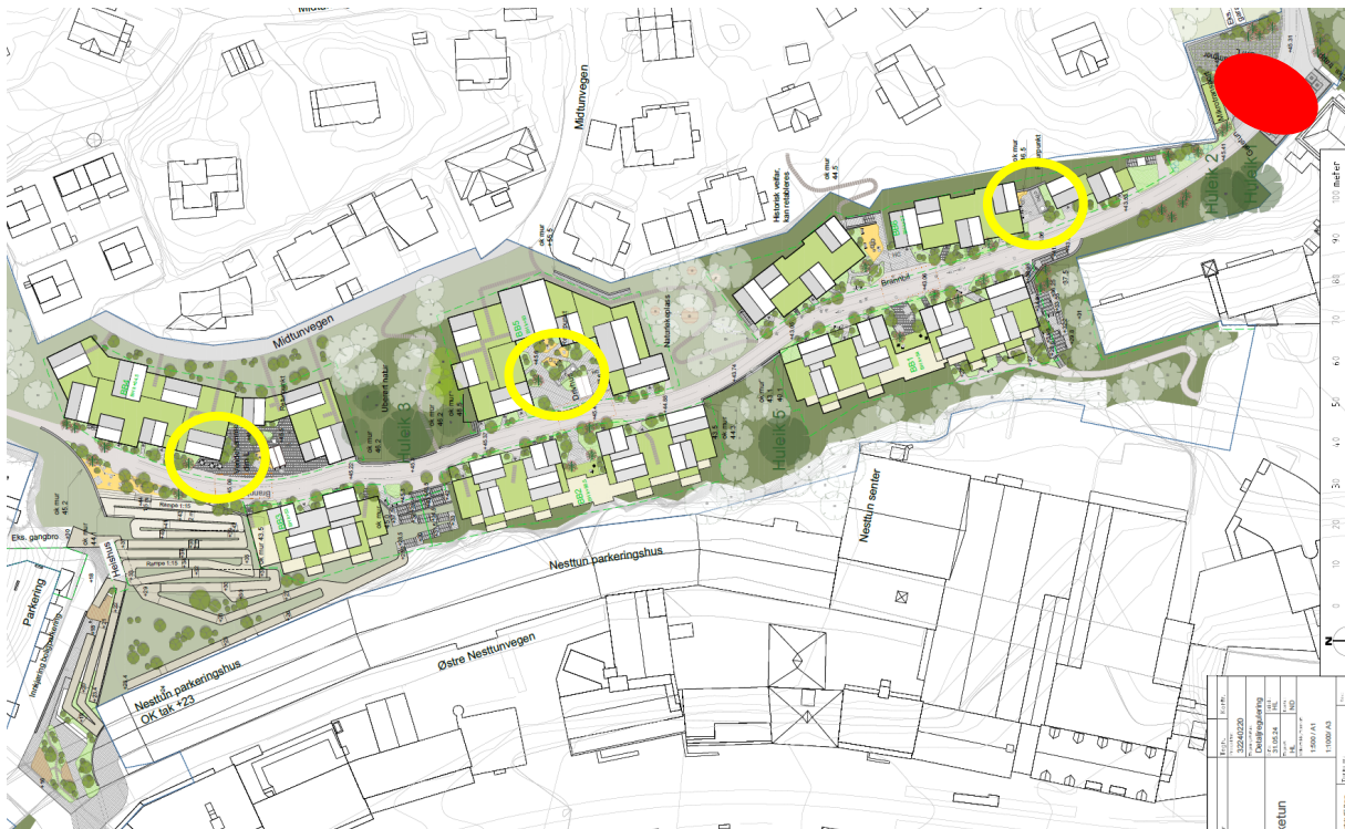
Figur 2: Utklipp som viser en oversikt over området med nedkast for restavfall (markert med gul sirkel) og renovasjons-HUB (markert med rød sirkel).
