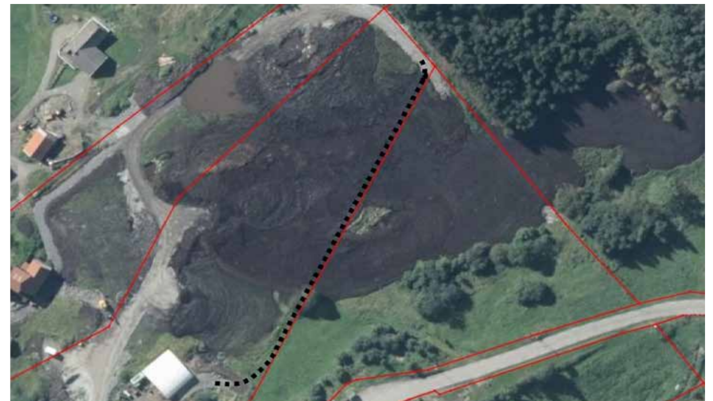
BILETET SYNER STODA RETT ETTER RASET. DEI NEDSTE EIGEDOMANE VAR IKKJE MED PÅ AVTALEN OM MOTTAK AV MASSAR. OM EIN HADDE LAGA EIN KØYREVEG (FLAUMVOLL) SLIK DEN STIPLA LINJA SYNER, VILLE SKADEN HA VORE UNNGÅTT. DENNE VEGEN MÅTTE ISTADEN LAGAS I ETTERTID FOR Å RYDDE OPP.
