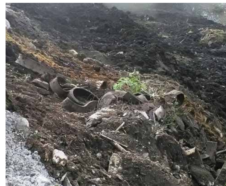
SYNLIG AVFALL IBLANDET JORDMASSER
