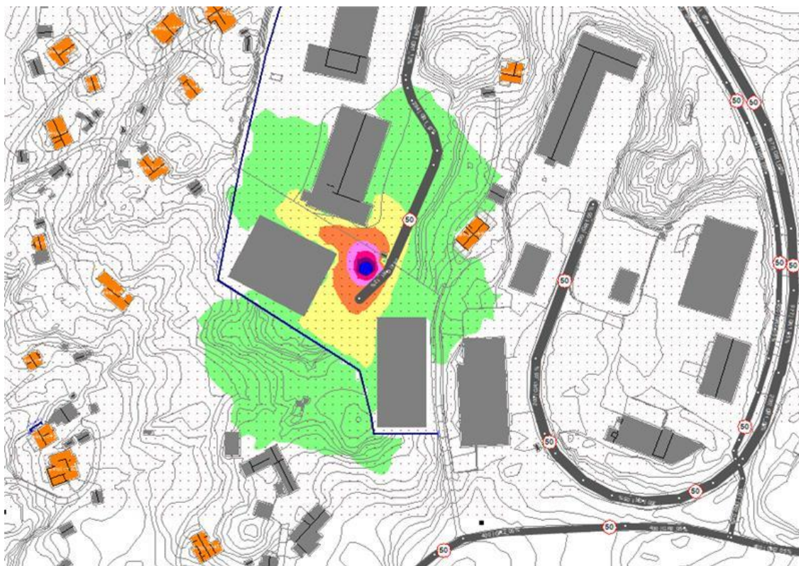
Figur 5-3: Spredning av lukt fra punktkilde med 500 000 luktenheter.
