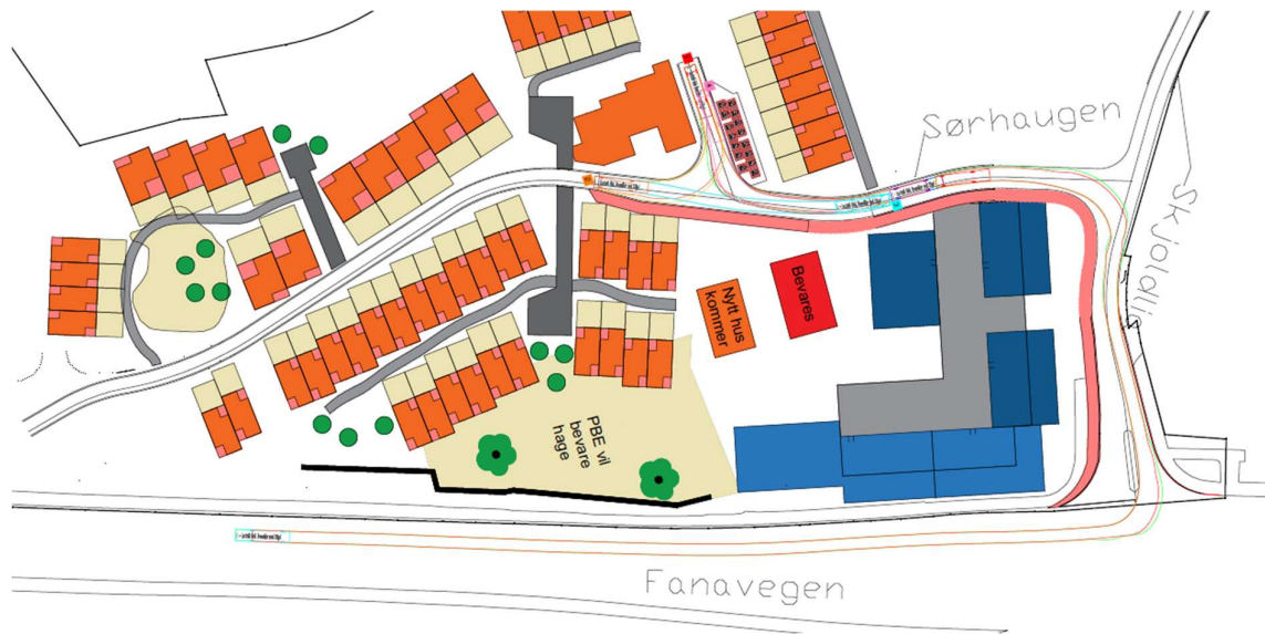
Figur 10: Sporingkurver fra Fanavegen via Skjoldlia og Sørhaugen frem til oppstillingsplass for renovasjon
