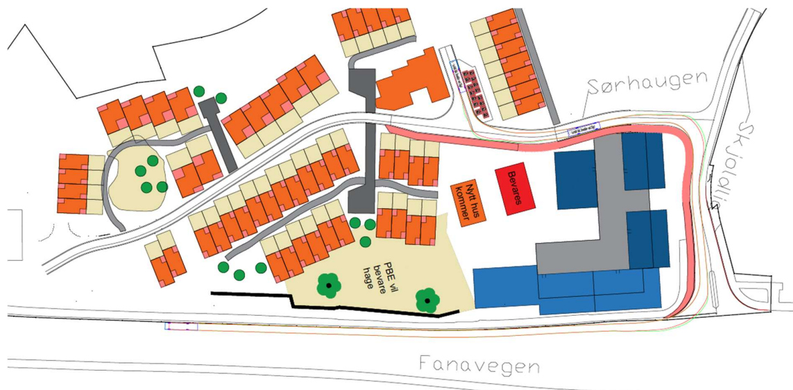
Figur 14: Springskurver for utkjøring fra oppstillingsplass, via Skjoldlia og ut i fanavegen
