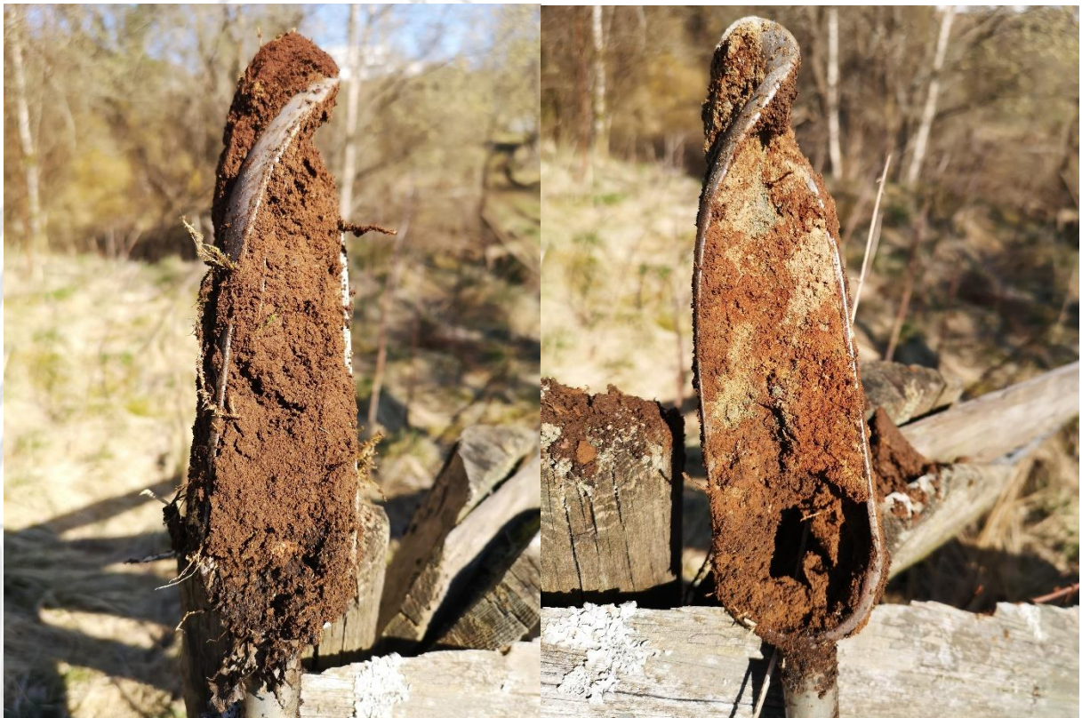
Bilde 7 og 8. Moldholdig siltig sand fra skråning, Prøvepunkt 1. A-sjikt t.v. og B-sjikt t.h. Foto NLR Vest
