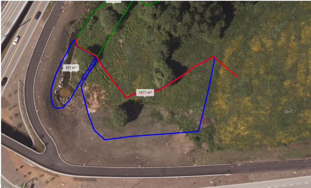
Fig. 5. «Myr» som er fylt opp med overskuddsmasser etter anleggsarbeid
