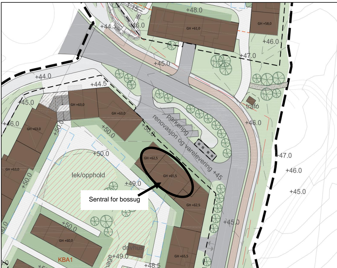
Figur 6: Lokalisering av bossug og bunntømte containere i planområdet.
