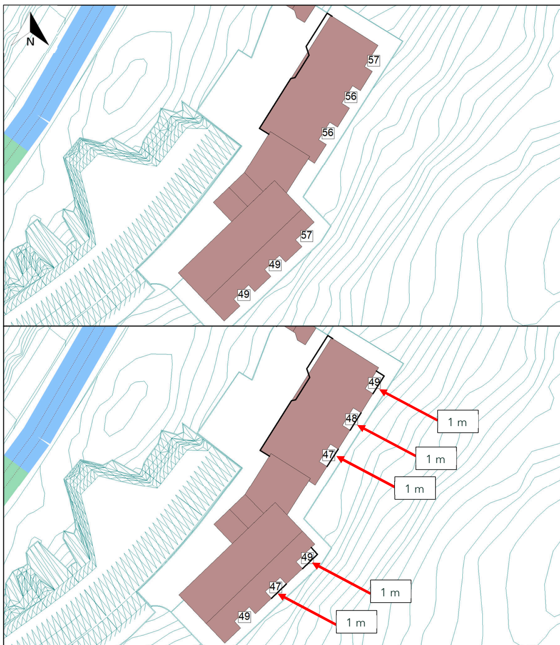
Figur 4-7: Støynivåer L_{den} på balkonger i 1. etasje. Uskjermet situasjon er vist øverst, skjermet situasjon er vist nederst. Skjermingshøyder er angitt i figuren.
