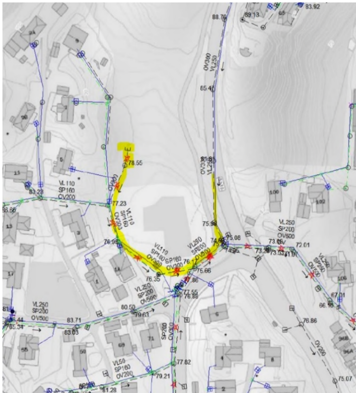
Figur 23: Viser VA-ledninger i prosjektområdet, markert med gult.
