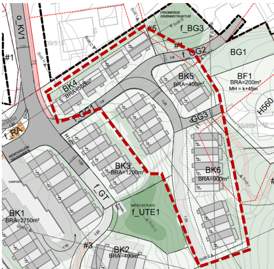
Figur 10. Oversikt over boliger som ikke vil få universell tilkomst fra bolig til parkering (boliger innenfor stiplede linje).
