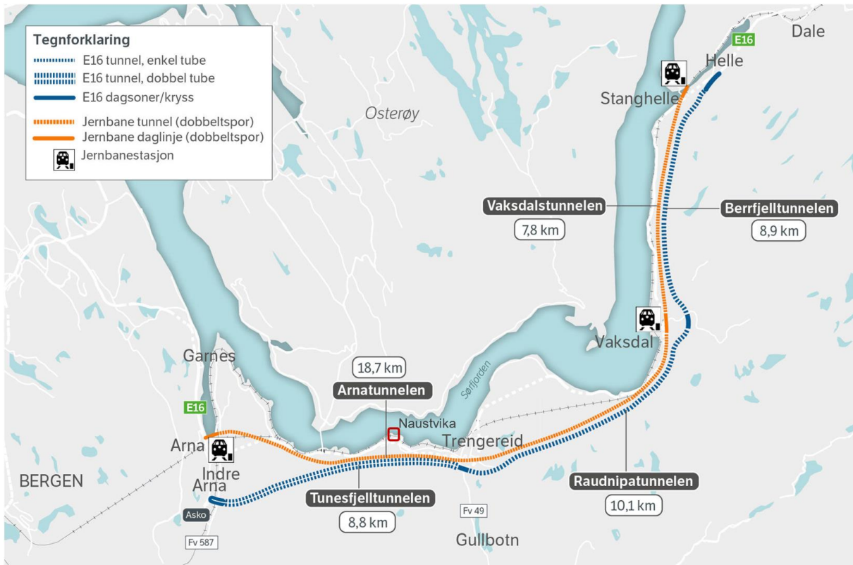
Figur 1-1: Jernbane- og vegtraseen som ble vedtatt i reguleringsplan for E16 og Vossebanen, Arna-Stanghelle. (Illustrasjon: SVV).
