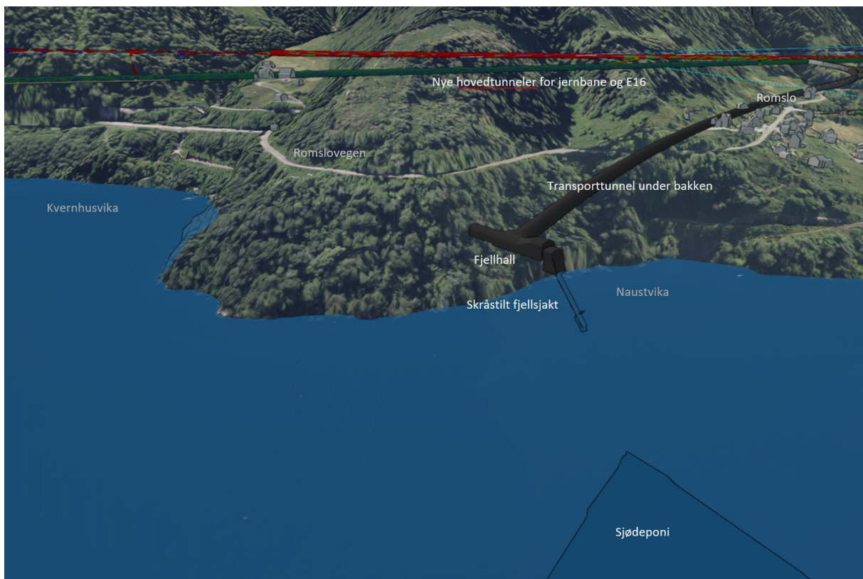
Figur 3-1 Illustrasjonen viser løsning for nedføring av masser fra fjellhall og sjakt til sjødeponi i Naustvika. (Kilde: FAS)
