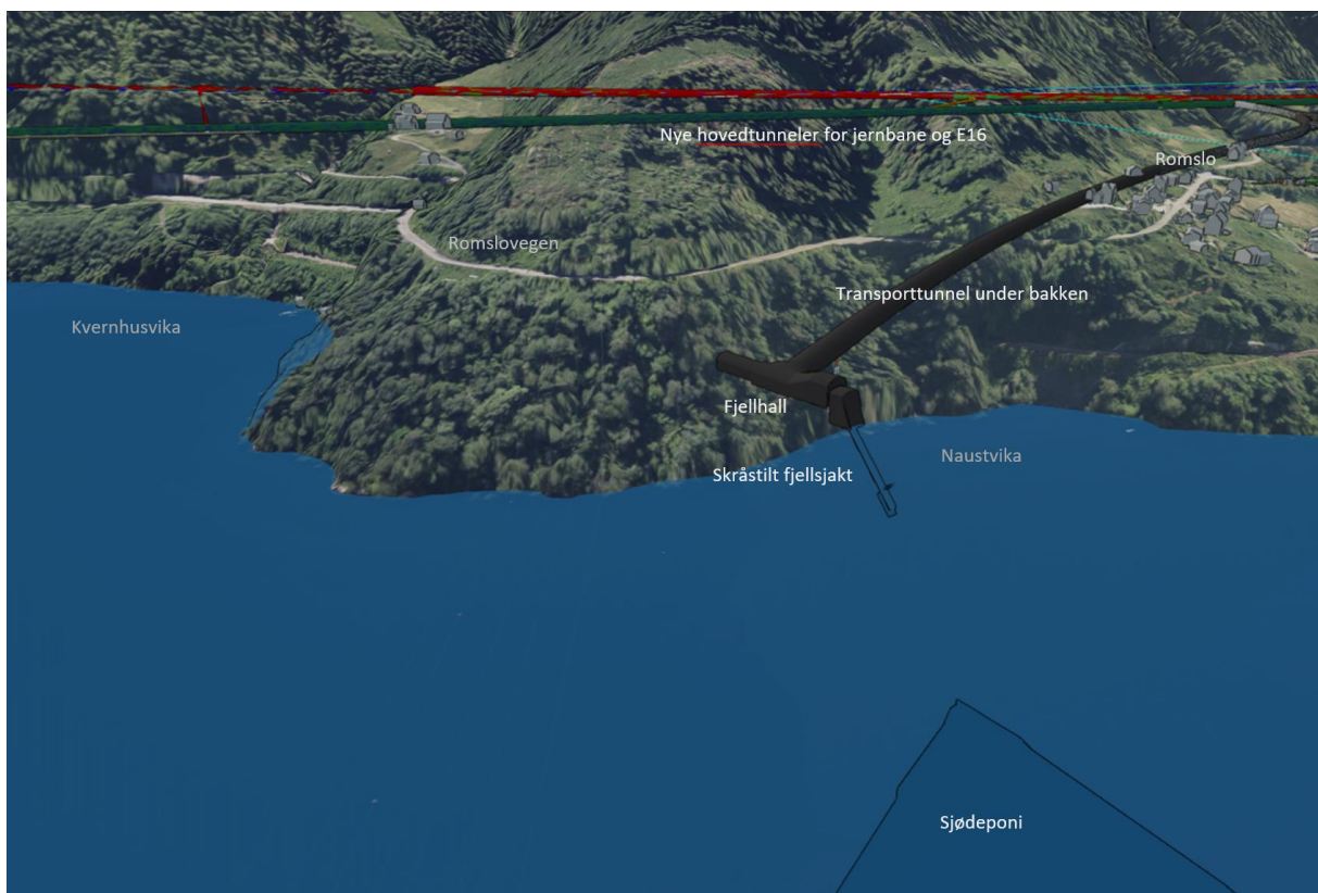
Figur 3-1 Illustrasjonen viser prinsippløsning for nedføring av masser fra fjellhall og sjakt til sjødeponi i Naustvika. (Kilde: FAS)
