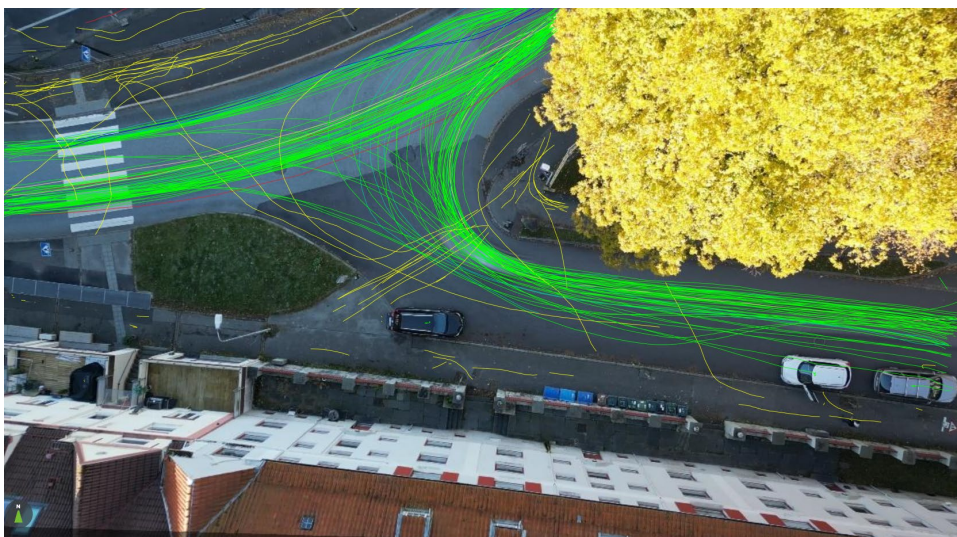
Figur 3. Utsnitt fra dronevideo som er benyttet som hjelpemiddel for analyse av kjøre- og gangmønstret i analyseprogrammet Goodvision.
