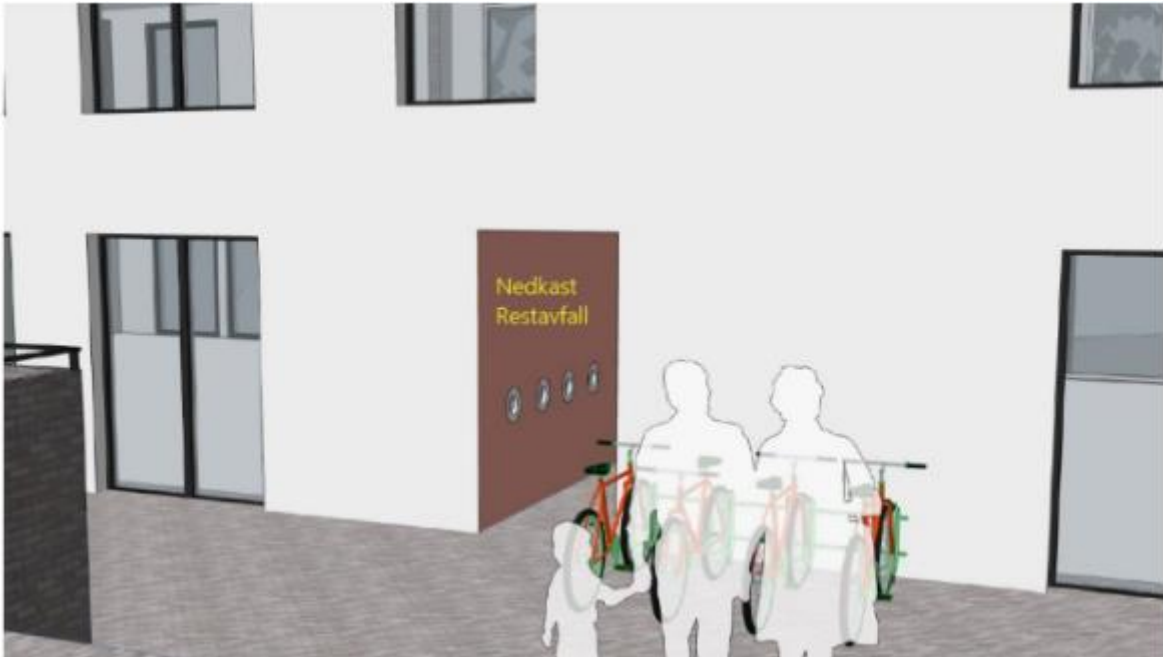
Figur 13: Nedkast til avfall i passasje på byggets nedside.
