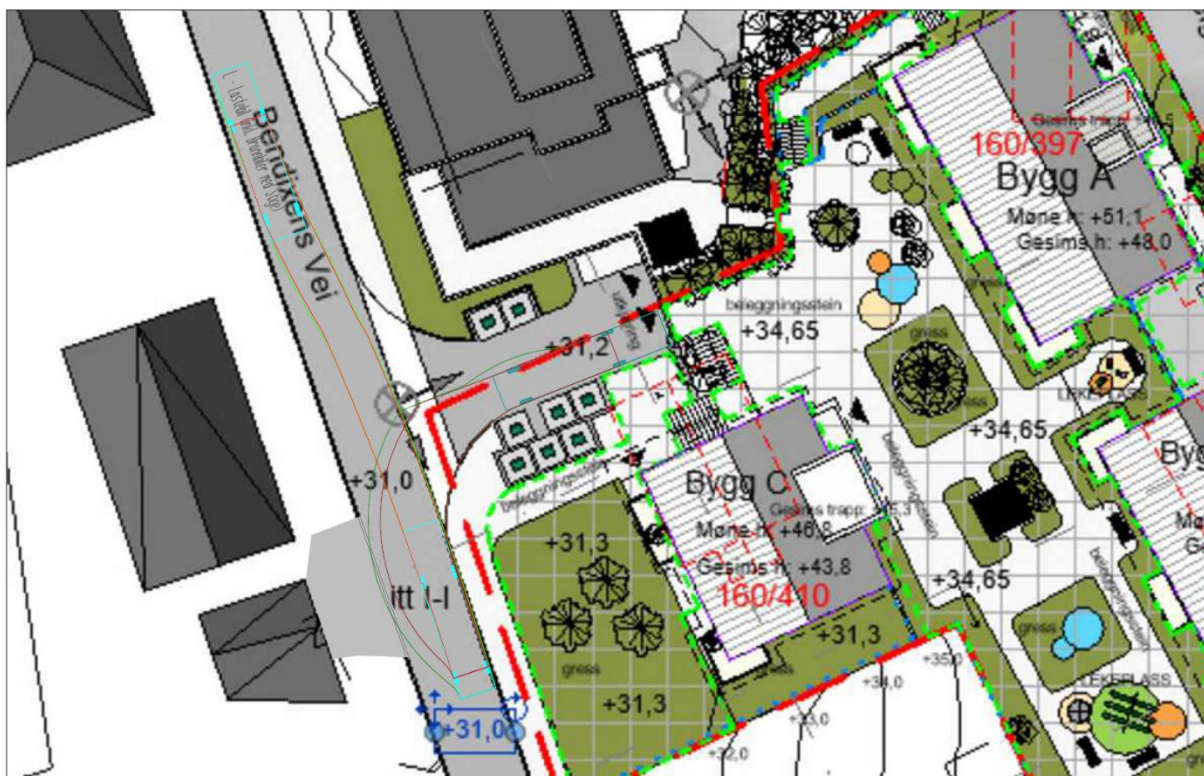
Figur 12: Sporingskurver av tilkomst til oppstillingsplass for renovasjonsbil. (Sporingskurven er utarbeidet av Ard Arealplan AS).
