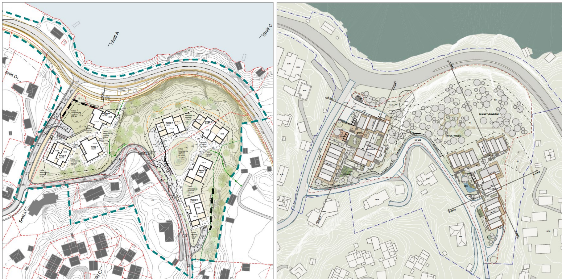
Figur 2-2: Illustrasjonsplan ved offentlig ettersyn 2018 t.v. (Cubus) og ved begrenset høring 2025 t.h. (Link). I gjeldende planforslag er bebyggelsen i større grad bestående av rekkehus i tillegg til leilighetsbygg, byggehøydene er trappet og bebyggelsen er sakset for bedre tilpasning til terrenget. Skrå fremfor flate tak demper inntrykket av bebyggelsen.
