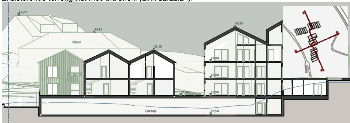
Figur 4-29: Snitt felt BB. Perspektiv mot nord; fasade mot gårdsrom. Parkering i 2 etg. under bakken Eksisterende terreng vist med blå strek. (Link 11.12.24).
