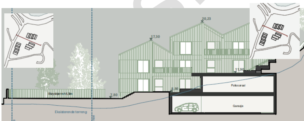
Figur 4-29: Snitt felt BB. Perspektiv mot nord; fasade mot gårdsrom. Parkering i 2 etg. under bakken Eksisterende terreng vist med blå strek. (Link 11.12.24).
