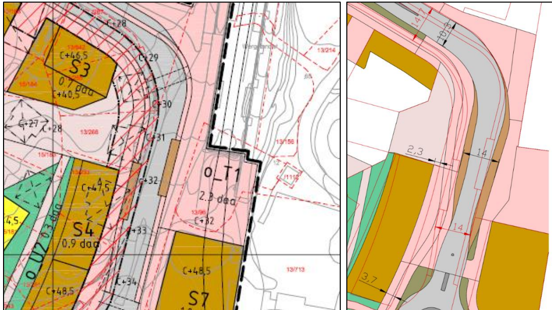
Til venstre: utsnitt av plankart for områderegulering for sentrale deler av Wergeland, med bussholdeplass som kantstopp. Til høyre: Formålsgrenser fra områdereguleringen er vist i rødt, over nytt planforslag (svart). Kjørebanelen, inkludert bussholdeplasser, er 14m bred i begge løsninger.
