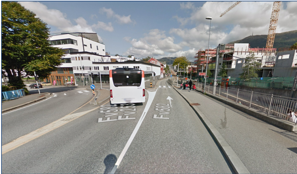
Figur 6-3 Bilde fra Google maps i Storetveitvegen, utsikt mot Fanahallen og Wergeland Bybanestopp. Flomvann kan renne via Fv 582 ned til bybanestoppet slik vegen ligger i dag, dette skal endres etter utbygging.
