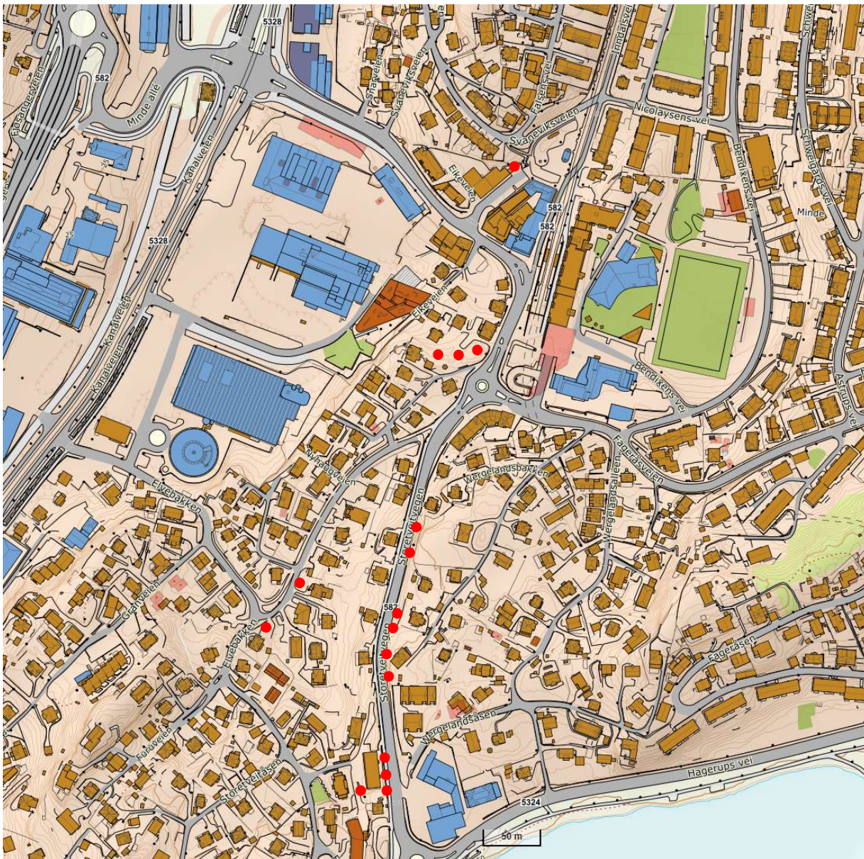
Figur 8: Kartlagt berg i dagen registrert på befaring 16.04.2024 markert i rødt.
