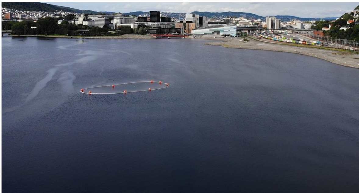
Figur 7 Oversiktsbilde som viser siltgardinen som ble etablert rundt kulturminnet D/S Topdal for beskyttelse.
