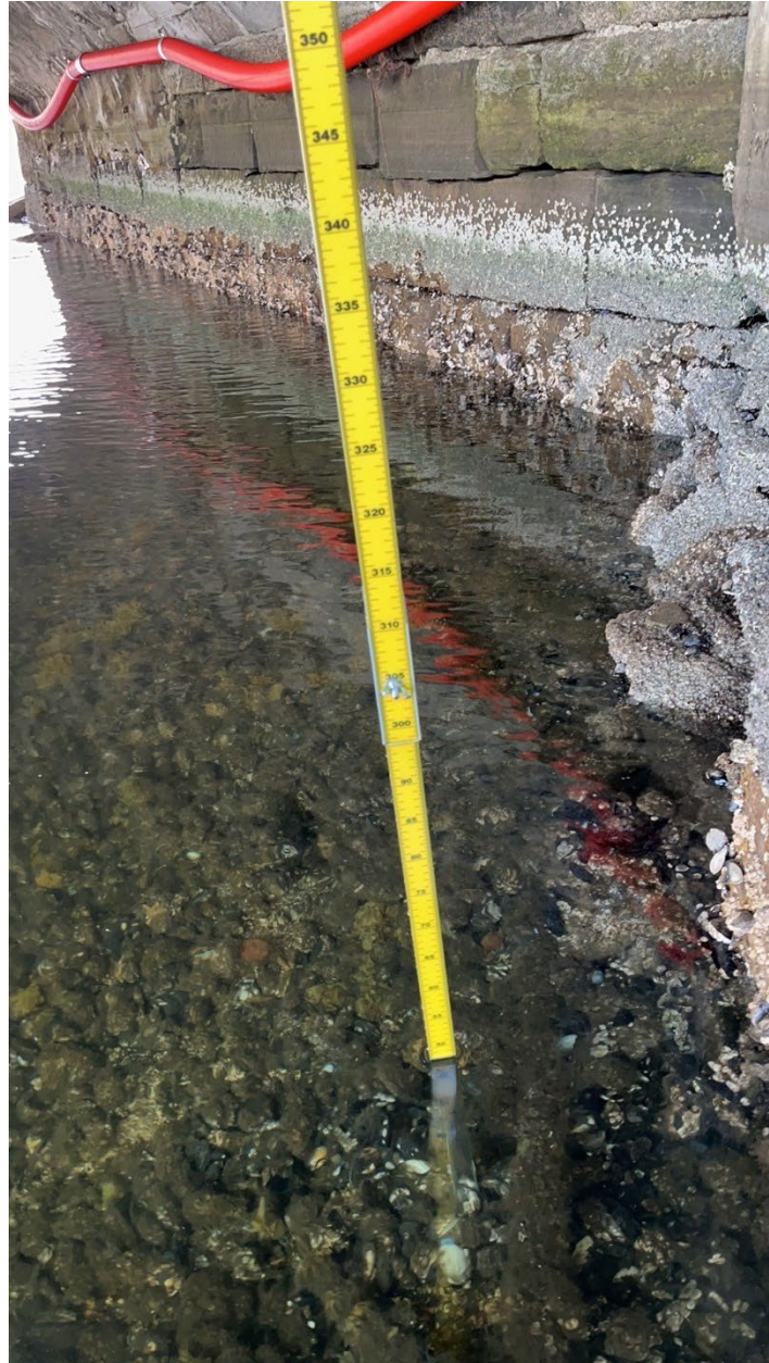
Figur 2: Innmåling av sjøbunn med nivellerstang.
