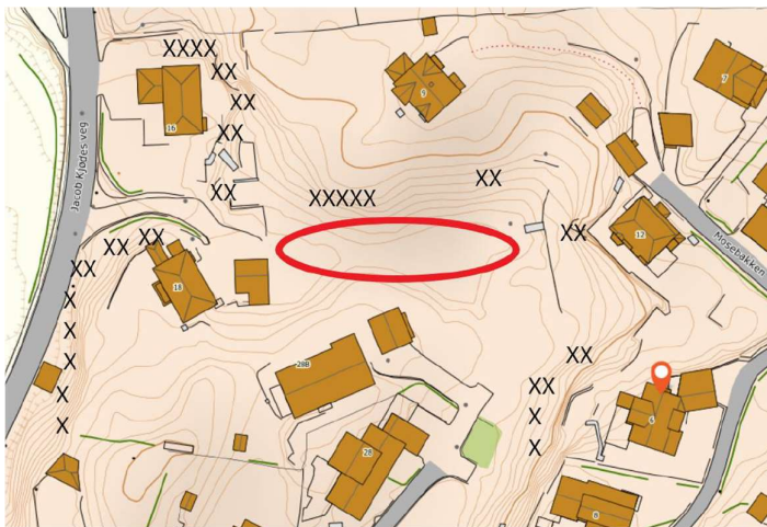
Figur 4 Markeringer av observert berg i dagen er markert med sorte "X". Område med løsmasser er markert med rød ellipse. Kilde: Instanes AS.
