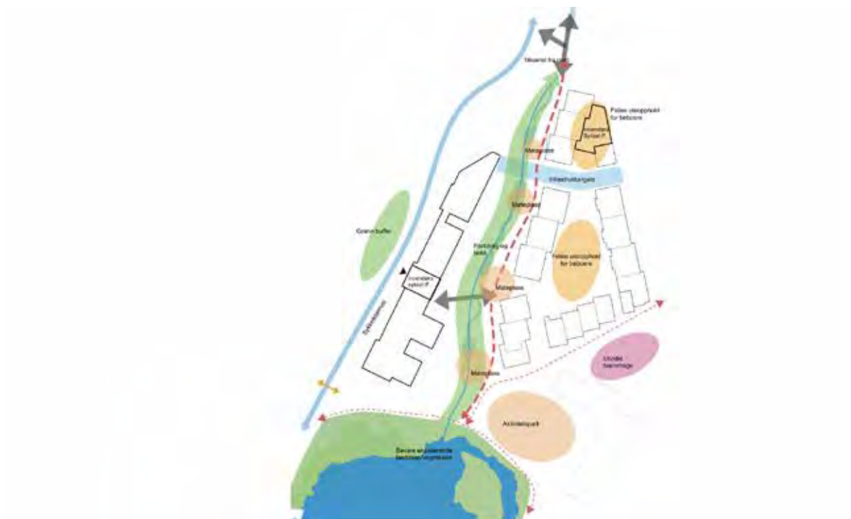
Skissa viser overordna plangrep. Eksisterande landskap/vegetasjon i sør skal bevarast, og bekk skal gjenopnast. Kjelde: b+b arkitekter AS.
