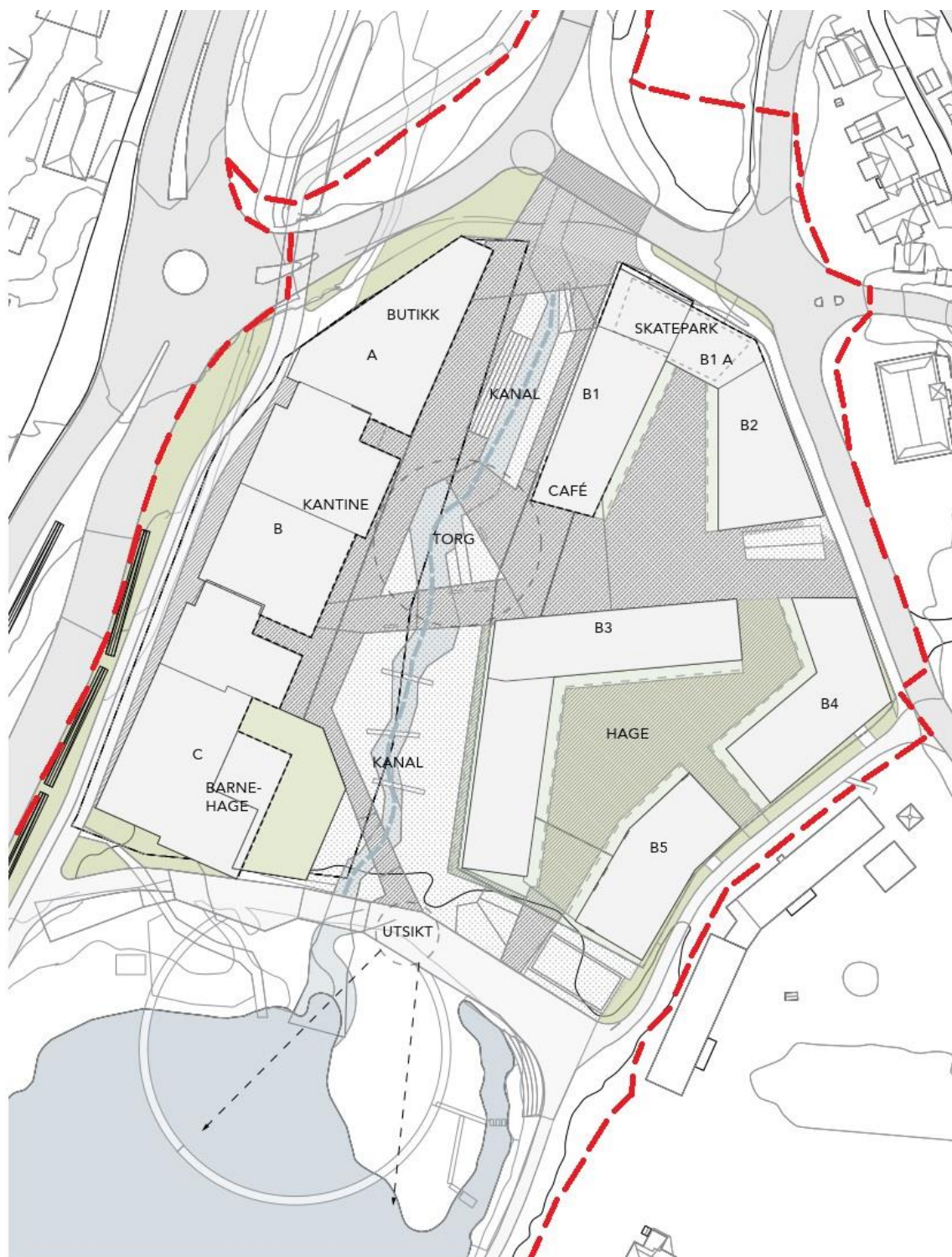
Figur 3. Planforslag med planlagt bruksformål. Bygning A, B og C reguleres til kontor og næringsvirksomhet, boliger og bofellesskap i bygninger B1-B5. Kilde: DelTa, B+B arkitekter AS, arkitektgruppen Cubus.
