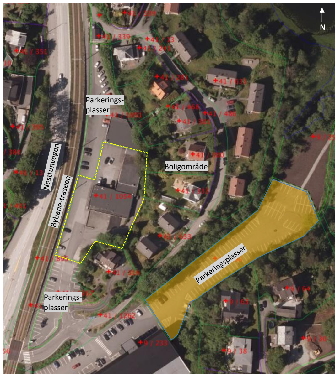
Figur 2.2: Flyfoto over undersøkt eiendom (avgrenset med gulstiplet linje) og nærområdet. Oransje-skravert område viser hvor det i Miljødirektoratets grunnforurensningsdatabase er registrert et lokalt deponi.
