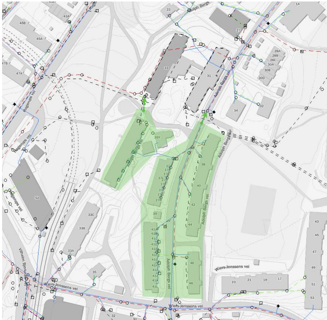
Figur 3: Nedslagsfelt for spillvann som krysser eksisterende kulvert.
