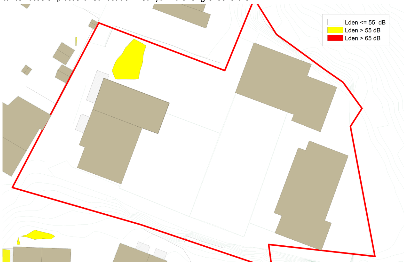
Figur 1: Støyutbredelse ( L_{den} ) fra støy fra vegtrafikk for 2044 for planområdet. Beregningen er 1,5 m over terreng, i vanlig vurderingshøyde for uteoppholdsareal.
