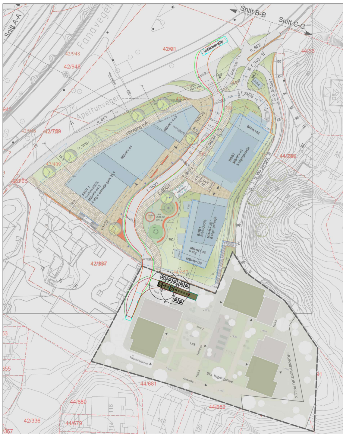
Figur 14: Sporingskurver av innkjøring til boligområdet for renovasjonsbil (Utarbeidet av Ard Arealplan AS).
