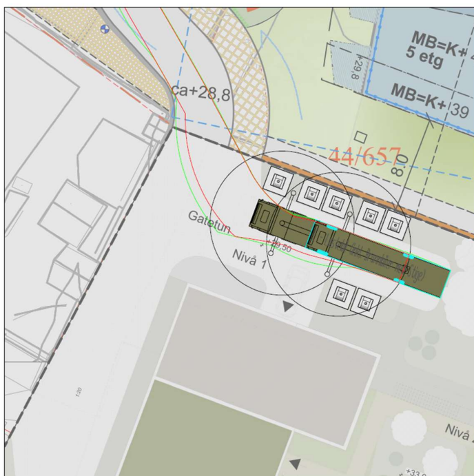
Figur 13: Sporingskurver av utkjøring fra oppstillingsplass for renovasjonsbil (Utarbeidet av Ard Arealplan AS).
