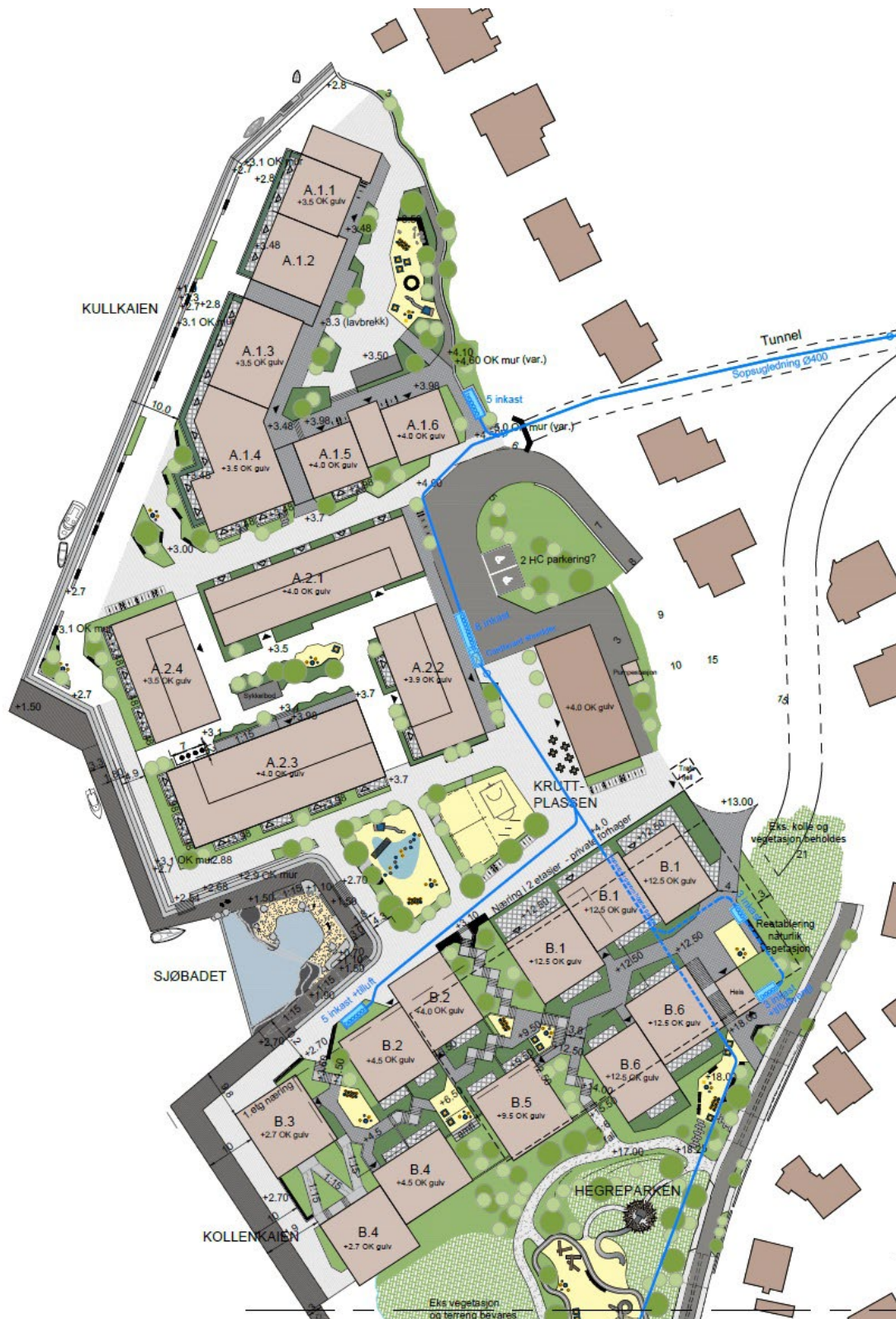
Figur 6: Viser utklipp av rørstrekk og nedkast for den nordlige delen fra vedlegget «Lay out system». Rørstrekk og nedkast er skissert med blått.
